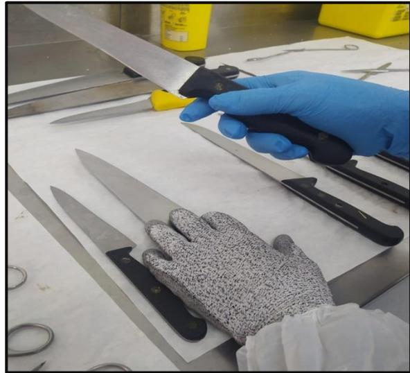
Detalle de guante anti-corte bajo el guante impermeable.
